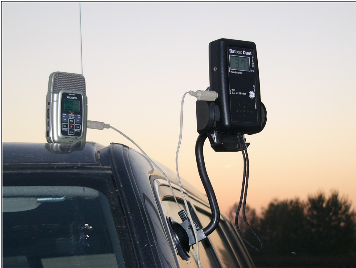
Ryc. 1. Detektor BatBox Duet i cyfrowy rejestrator dźwięku ZOOM H2 podczas nasłuchów w punkcie nasłuchowym.
