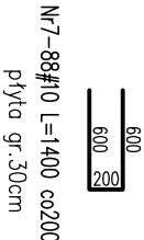
PRĘTY OBWODOWE KIERUNEK X skala 1:50
